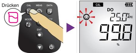
4. Drücken Sie die ENT-Taste, um die DO Messung zu bestätigen. Drücken Sie die MEAS-Taste, zum Abbrechen der Kalibrierung.
