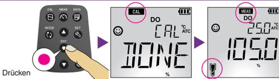
5. Tauchen Sie die DO-Elektrode in die Nulllösung (5% Natriumsulfit) ein und wiederholen Sie die Schritte Nr. 3-4, um eine Nullpunktkalibrierung durchzuführen (optional).
